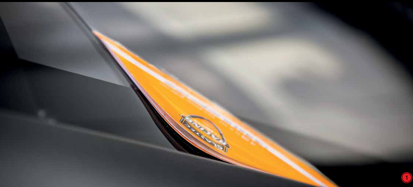
[1] ABREISSFOLIE FRONTSCHIEBE Schutzfolie für Windschutzscheibe 4-lagig
