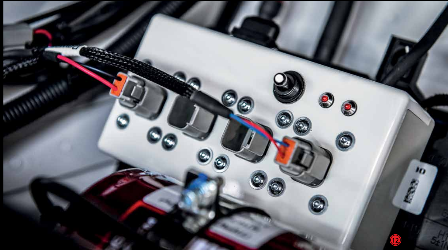
[11] CAN GATEWAY KIT CAN Schnittstelle für den obligatorischen Datenlogger analog der SRO Regularien
